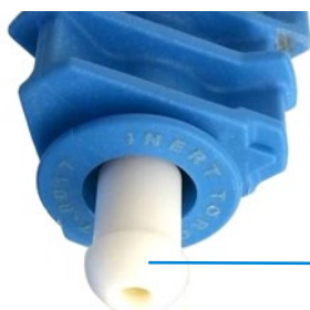
Figura 2. Junta esférica PTFE conectada al tubo inyector.
